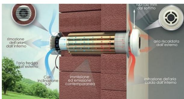
meccanica controllata (VMC) in ciascuna aula al fine di garantire un ricambio dell'aria ideale in base ai volumi delle aule
